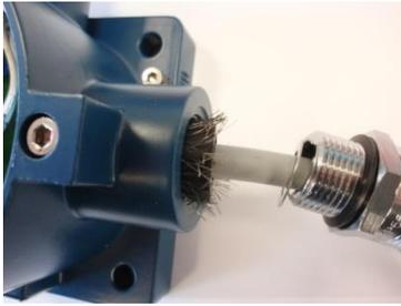
4- Insérer l'ensemble dans le capteur et monter le presse-étoupe.
